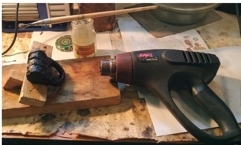
Рис. 6 Консервація експонату (розчин полімеру COSMOLOID-80).
